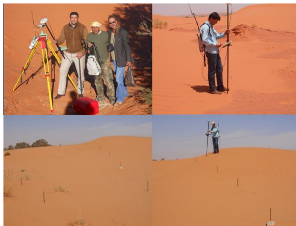
Photos.16-19. Stations fixe et mobile et mesure RTK.
