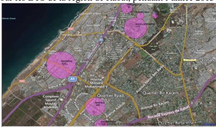
Figure 5 : Affichage sur une Image satellitaire « BingMap » de la densité relative du trafic des BTS de la région de Rabat pour l'année 2013
