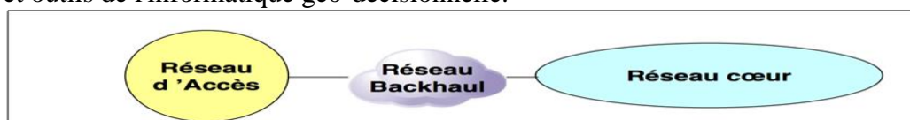
Figure 1 Schéma générique d'un réseau de téléphonie mobile (Source : (« EVOLUTION_MOBILE_EFORT.pdf » 2016, 1)
